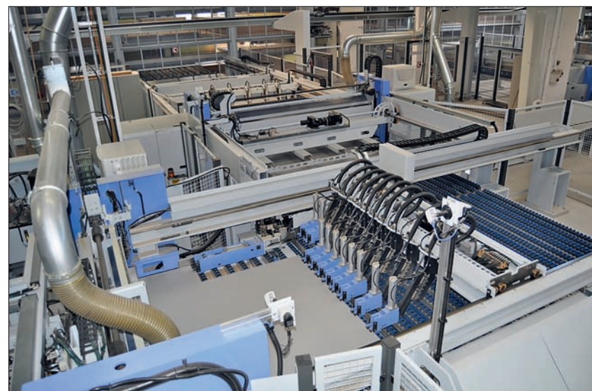
Die „Holzma HKL 380 Combi Line“ ist eine Winkelanlage, die über ein Fräsaggregat auf der Längssäge verfügt und mittels variabler Spannanzgen eine maximale Schnittoptimierung gewährleistet.
