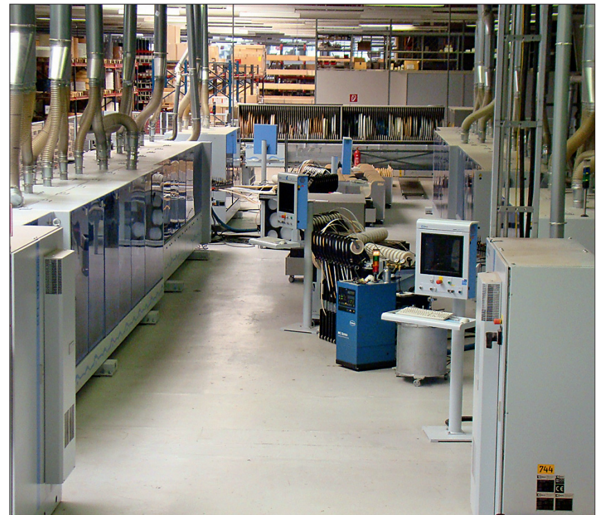
Format- Nut- und Kantenbearbeitungsstraße in U-Form für zwei Durchläufe zur Bearbeitung aller Hali-Teile in Lösgröße 1 Fotos: Homag
