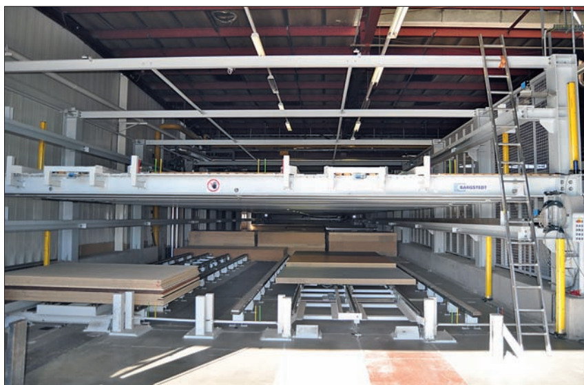
Das Zwei-Etagen-Plattenlager ermöglicht den Zugriff auf die doppelte Menge der Lagerplätze und reduziert so die Zugriffszeit auf die 175 verschiedenen Platten-Sorten. Rechts davon befindet sich das automatische Restelager.
